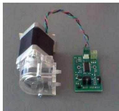
Fig. 5: Peristaltic motor
