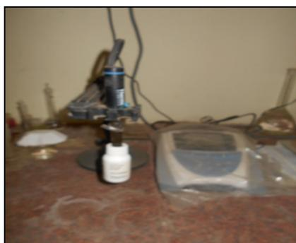
Fig. 2: Glass electrode pH meter
